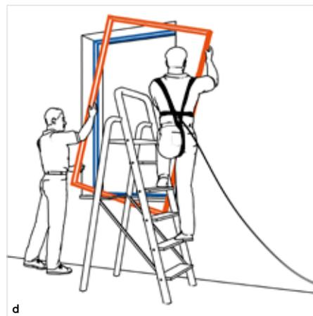
Das fertige Fenster wird erst in der trockenen Bauphase eingesetzt, also nach Abschluss aller schmutzigen Arbeiten. So sind Beschädigungen nahezu ausgeschlossen.
