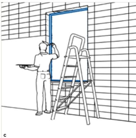
Für die weiteren Arbeiten auf der Baustelle bietet die Zarge nun definierte Schnittstellen, etwa exakte Anputzkanten, für die folgenden Gewerke.
