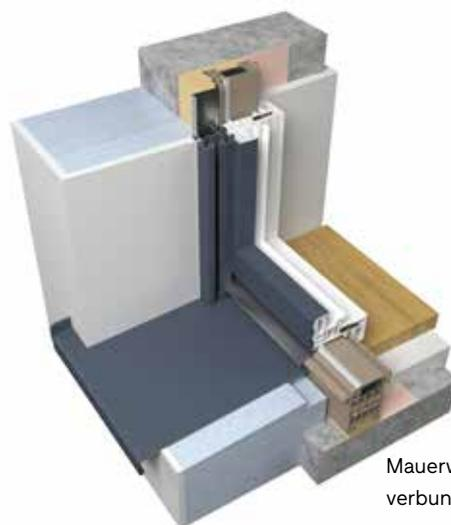
Mauerwerk mit Wärmedämmverbundsystem
