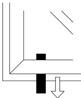
Öffnen Sie das Fenster und klemmen Sie den Papierstreifen an einer Stelle ohne Verriegelungen ein. Schließen Sie das Fenster und versuchen Sie, das Papier herauszuziehen. An mehreren Stellen testen.
