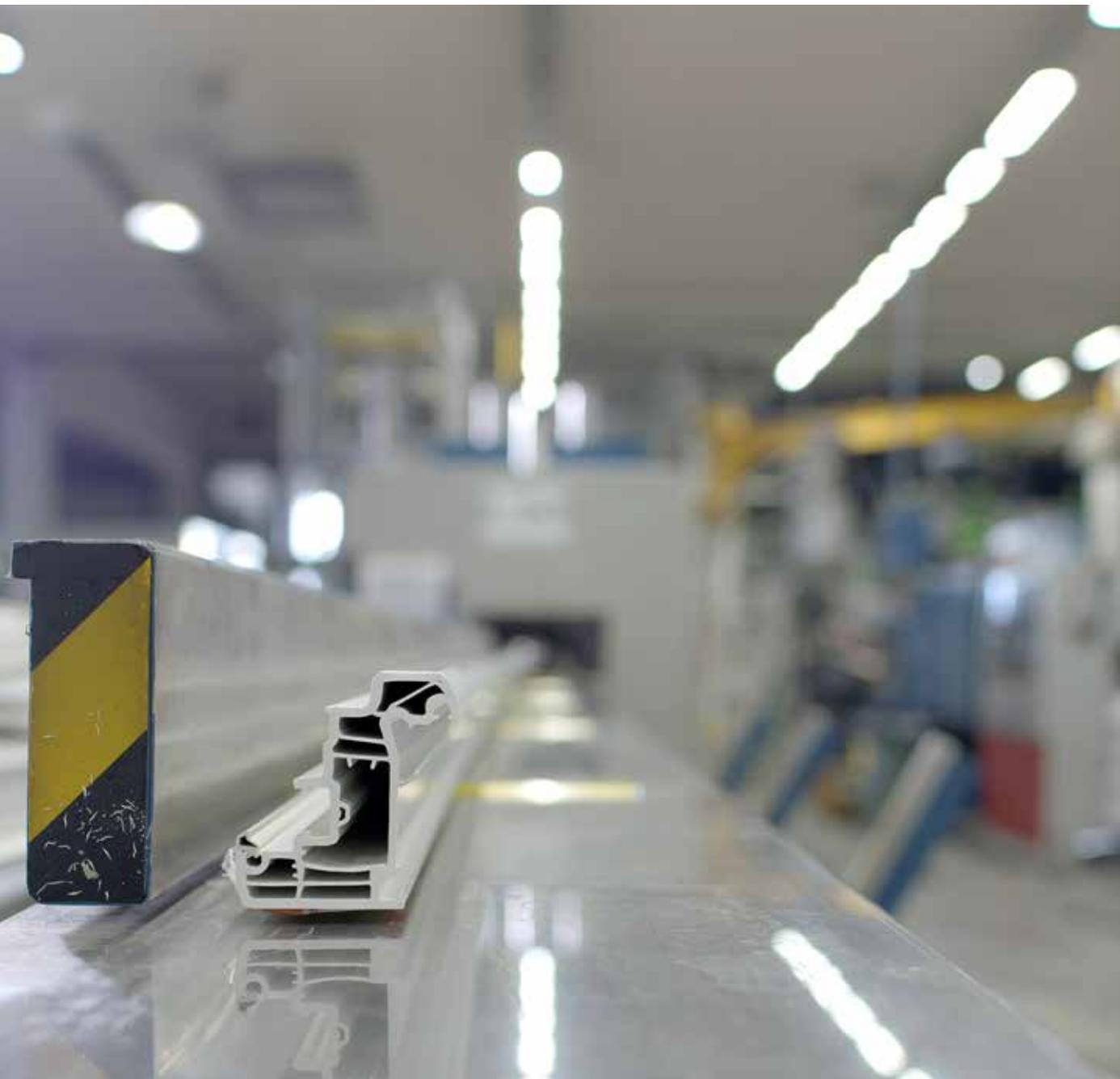
Funktioniert im Prinzip wie eine Nudelpresse: Extrusion eines Kunststoffprofils in unserem Werk in Kurtatsch (Südtirol/Italien).
