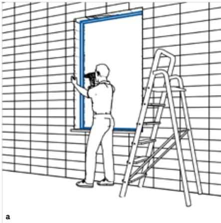
Die Montagezarge FIN-Fix wird im Rohbau montiert. Neben der Vorbereitung für das Fenster kann die Zarge ab Werk auch bereits Ergänzungen für Rollläden, Elektrik, Lüfter oder anderes enthalten.
