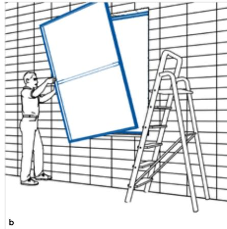
Die Laibung bleibt in der nassen Bauphase offen, damit der Baukörper optimal entlüften kann. Optional kann die Öffnung temporär mit einer Windfolie verschlossen werden.
