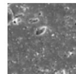
Verdichtete Oberfläche eines extrudierten, extraglaten Kunststoffprofils von Finstral (stark vergrößert).
