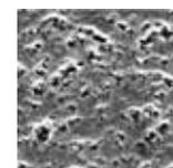
Herkömmliche glatte Oberfläche eines extrudierten Kunststoffprofils (stark vergrößert).
